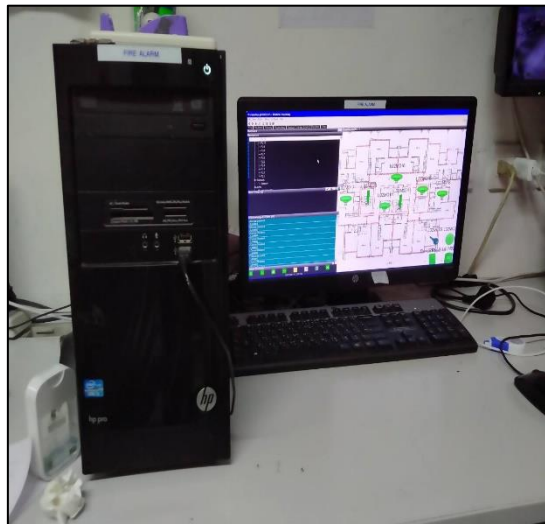
ภาพที่ 2.21 ระบบ และตารางควบคุมการเปิดปิดไฟในพื้นที่ส่วนกลางโครงการ
